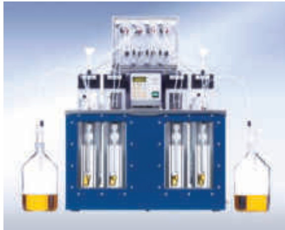
Fig. 5 - Sistemi automatik i matjes për te viskozimetrat kapilar
